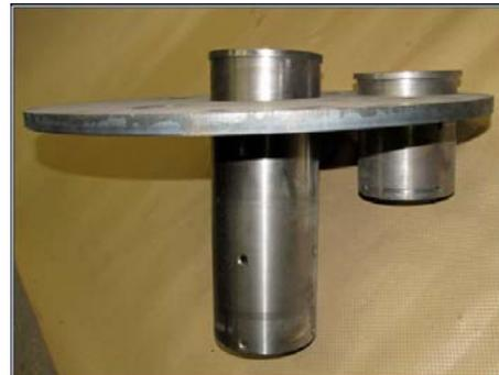
④ 標準プレートでは、チューブとプレートを溶接して内径を削りますが、サブスピンドルプレートでは、サブ用チューブの芯が出なのでボルト締めです。
