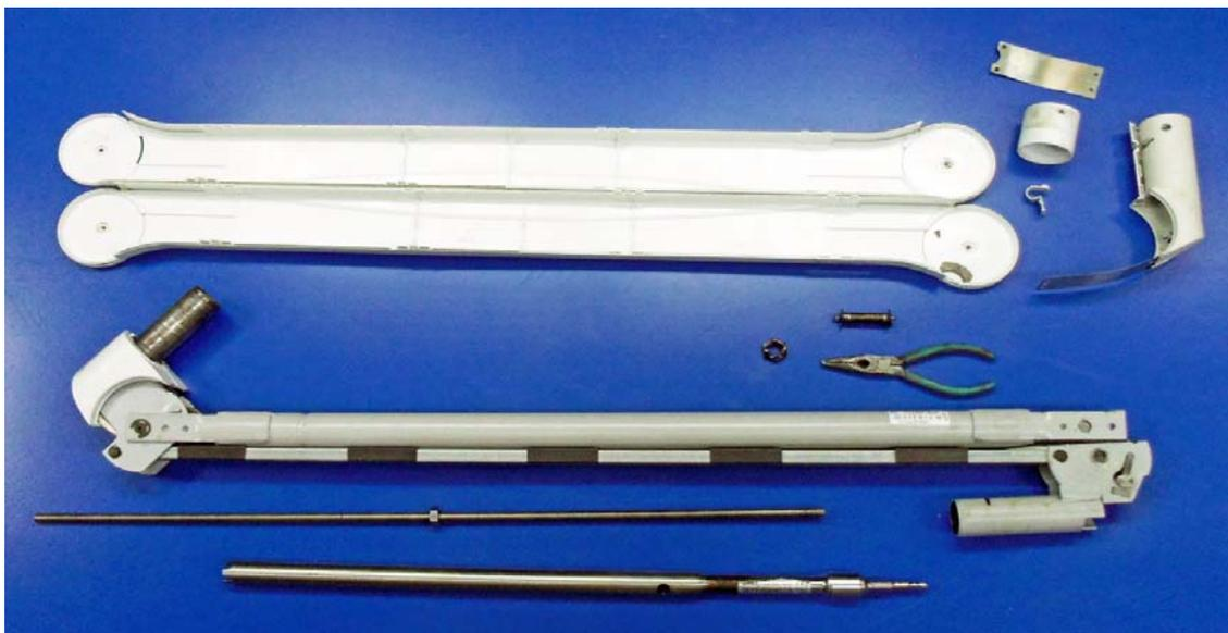
① 通常では、スプリングアームの標準強度範囲内で支える重量の微調整を行います。この調整棒は直接スプリング全体を強弱させます。
